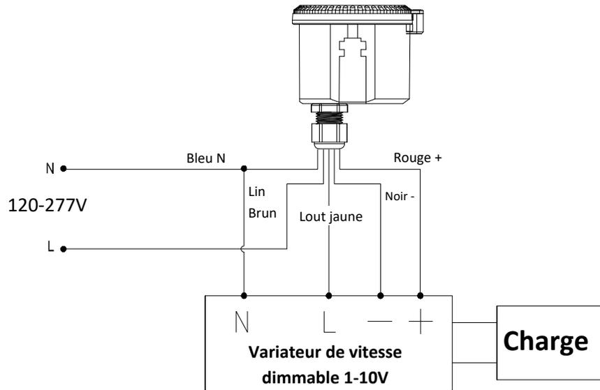
Figure 5: Schéma de câblage
